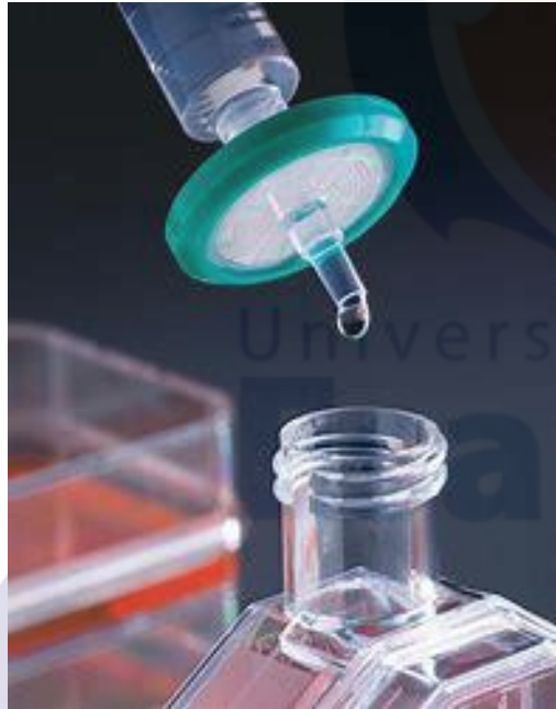
Gambar 13. Proses sterilisasi dengan mikrofilter dilakukan untuk menyaring bakteri dan virus.
