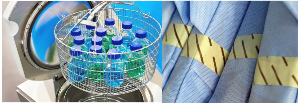
Gambar 10. Media kultur (kiri) dan peralatan (kanan) bisa disterilisasi di autoclave.
